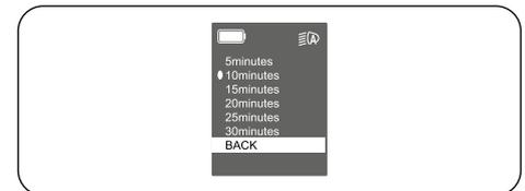
Wählen Sie die gewünschte Zeit und verlassen Sie die Ansicht über „BACK“. Sobald die eingestellte Zeit ohne Aktivität verstrichen ist, schaltet sich das elektrische System des Pedelecs automatisch ab. Eine neu eingestellte Zeit wird erst wirksam, nachdem das Display ausgeschaltet und wieder eingeschaltet wurde.
