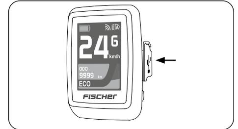
Am Display befindet sich eine USB-Ladebuchse. Die USB-Ladefunktion kann über das Menü ein- oder ausgeschaltet werden. Alternativ lässt sich die Funktion auch direkt über die „+“-Taste steuern. Halten Sie die „+“-Taste so lange gedrückt, bis das USB-Symbol auf dem Display erscheint oder erlischt.
