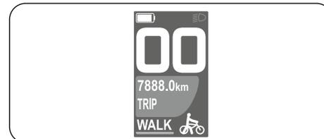
Drücken Sie die „v“-Taste kurz hintereinander bis auf dem Display die Unterstützungsstufe „WALK“ angezeigt wird. Halten Sie dann die „v“-Taste für mindestens 2 Sekunden, um die Schiebehilfe zu aktivieren. Der Motor unterstützt Sie beim Schieben Ihres Pedelecs mit einer Geschwindigkeit von bis zu 6km/h. Sobald Sie die „v“-Taste loslassen, wird die Schiebehilfe wieder deaktiviert.
