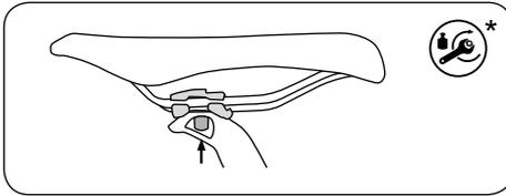
Patentstütze mit Einschraubbefestigung
