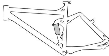
Hier ist der Hinterbau des Rahmens beweglich gelagert und mit einem Stoßdämpfer gefedert und gedämpft. Es gibt Stoßdämpfer, die mit einer Metallfeder federn und solche, wo diese Aufgabe eine Luftkammer übernimmt. Die Dämpfung, die die Geschwindigkeit beim Ein- und Ausfedern reguliert, ist bei hochwertigen Stoßdämpfern einstellbar.
