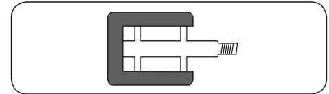
Vergewissern Sie sich, dass die Räder sicher in Rahmen und Gabel befestigt sind. Prüfen Sie den festen Sitz der Schnellspanner, Steckachsen und aller wichtigen Befestigungsschrauben und -mutter (siehe Seite 11 und 32).
