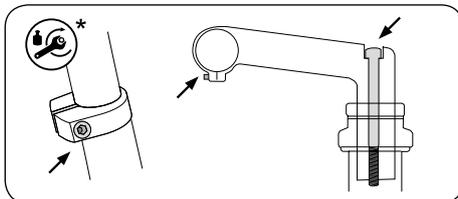
Mögliche Positionen von Schraubverbindungen zur Anpassung
