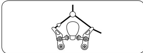
Cantilever- oder V-Bremse öffnen:
