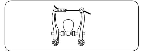
Falls ein Bremsgummi an der Felge schleift: Durch die Federeinstellschrauben können Sie die Rückfederkraft so einstellen, dass sich beide Bremsgummis gleichmäßig von der Felge abheben, wenn Sie den Bremshebel loslassen. Anschließend überprüfen Sie die korrekte Funktion der Bremse.
