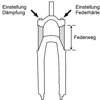
Die Abstimmung einer Federgabel muss nach Bedienungsanleitung des Gabelherstellers erfolgen. Generell gilt, dass die Gabel beim Überfahren von Unebenheiten merklich arbeiten, aber nicht „durchschlagen“, also bis auf Anschlag einfedern sollte.
