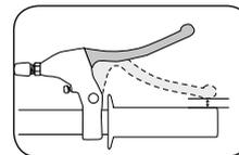
Stellen Sie die Bremshebel so ein, dass der Bremshebel auch bei starker Betätigung nicht den Lenkergriff berührt!
