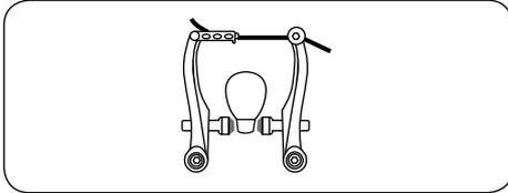
Falls ein Bremsgummi an der Felge schleift: Durch die Federeinstellschrauben können Sie die Rückfederkraft so einstellen, dass sich beide Bremsgummis gleichmäßig von der Felge abheben, wenn Sie den Bremshebel loslassen. Anschließend überprüfen Sie die korrekte Funktion der Bremse.
