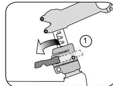
2. Drehen Sie den Lenker um 90 Grad bis die Arretierung sichtbar- und hörbar einrastet und der Verriegelungsbolzen ② am Vorbau sichtbar ist.
