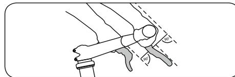
Um die Bremshebel auch bei kleineren Händen sicher greifen zu können, wird der Bremshebel mit einer Stellschraube (im Hebel) weiter an den Lenker herangestellt.
