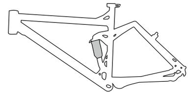
Hier ist der Hinterbau des Rahmens beweglich gelagert und mit einem Stoßdämpfer gefedert und gedämpft. Es gibt Stoßdämpfer, die mit einer Metallfeder federn und solche, wo diese Aufgabe eine Luftkammer übernimmt. Die Dämpfung, die die Geschwindigkeit beim Ein- und Ausfedern reguliert, ist bei hochwertigen Stoßdämpfern einstellbar. Ein typisches Federelement kann so aussehen:
