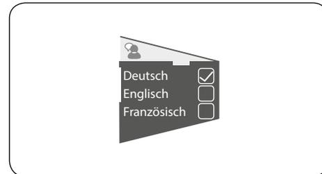
Wählen Sie die gewünschte Sprache und bestätigen Sie die Auswahl. Für den Wechsel der Sprache ist kein Neustart notwendig. Es kann allerdings zu einer kurzen Wartezeit kommen, in der das Bedienelement nicht reagiert. Durch Drücken des Joysticks nach links bei Montage an der rechten Lenkerseite bzw. durch Drücken nach rechts bei Links-Montage gelangen Sie wieder in den Editier-Modus.
