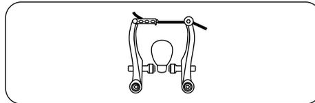
Falls ein Bremsgummi an der Felge schleift: Durch die Federeinstellschrauben können Sie die Rückfederkraft so einstellen, dass sich beide Bremsgummis gleichmäßig von der Felge abheben, wenn Sie den Bremshebel loslassen. Anschließend überprüfen Sie die korrekte Funktion der Bremse.
